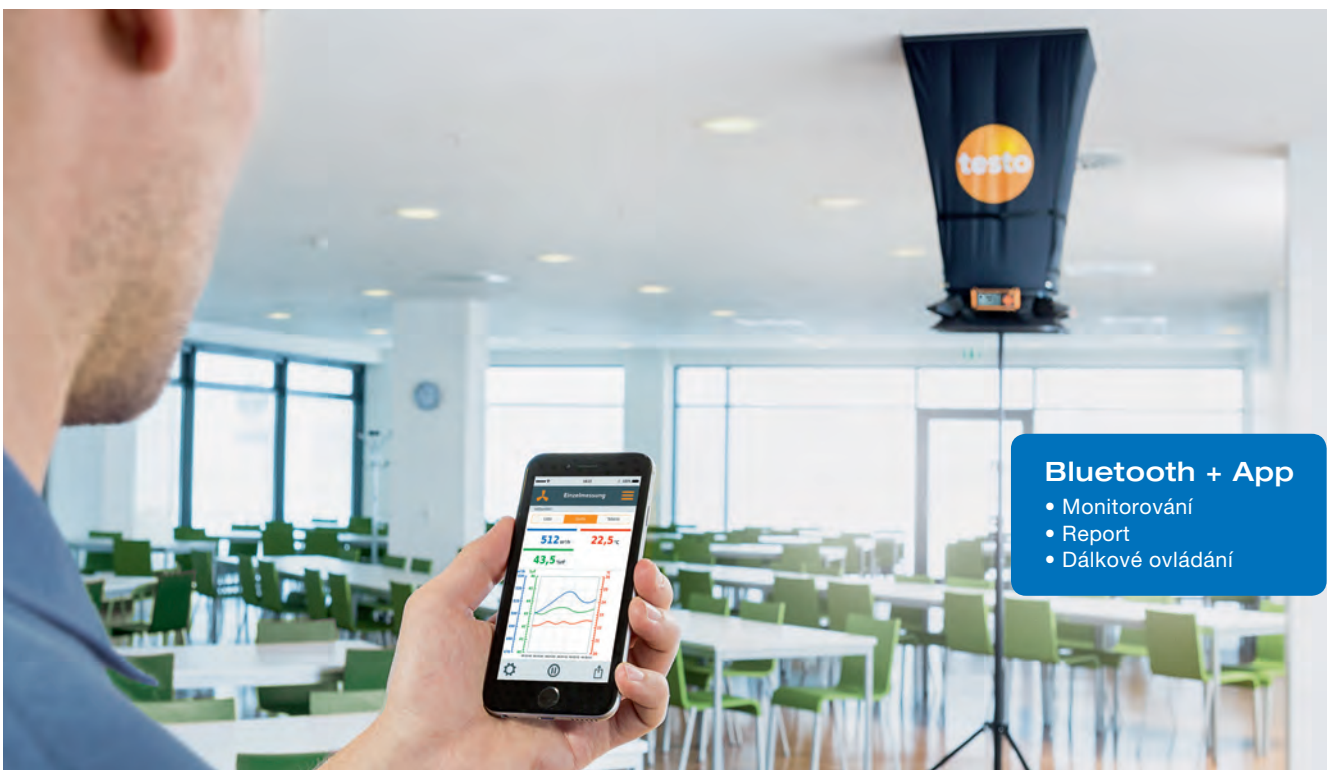
Bez usměrňovače proudění může být výsledek měření zkreslený vířením vzduchu.
