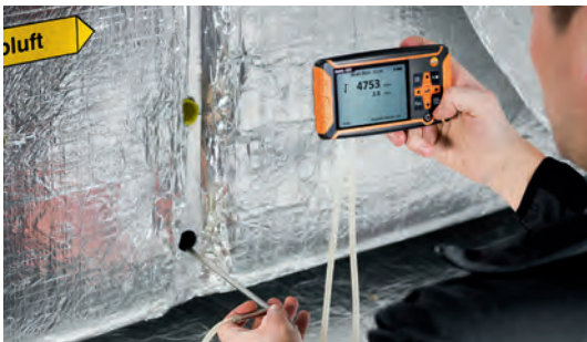
Měření v kanálu pomocí Prandtlovy trubice.
