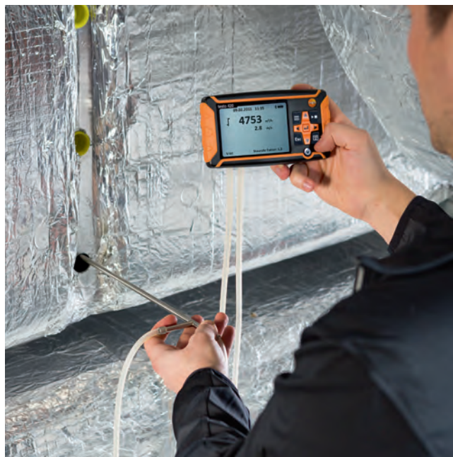
Odnímatelný přístroj umožňuje měření v kanálu pomocí Prandtlovy trubice (Prandtlova trubice samostatně na objednání).
