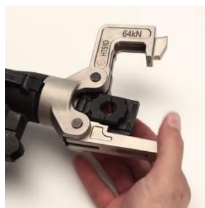
Nasazení matrice podle průměru
