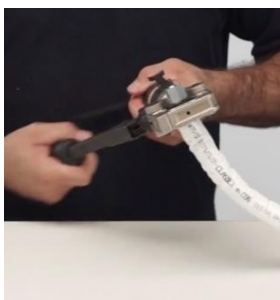
Lisování manuálními kleštěmi
